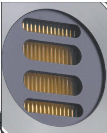
Hinter den schützenden Streben verbergen sich ultrastarke Neodym-Magneten. In dem Magnetfeld schwingt die ziehharmonikaartig gefaltete JET-Membran, eine sehr leichte magnetostatische Folie mit aufgeklebten Leiterbahnen. Im Gegensatz zum klassischen Magnetostaten bietet sie eine um den Faktor 4 vergrößerte effektive Membranfläche bei identischer Abstrahlfläche.
