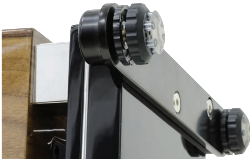
La base del diffusore da un lato si preoccupa di distanziare l'uscita del condotto reflex dal pavimento e dall'altro di regolare finemente la posizione del diffusore indipendentemente dalle irregolarità del pavimento. In dotazione è fornita anche una serie di punte.
