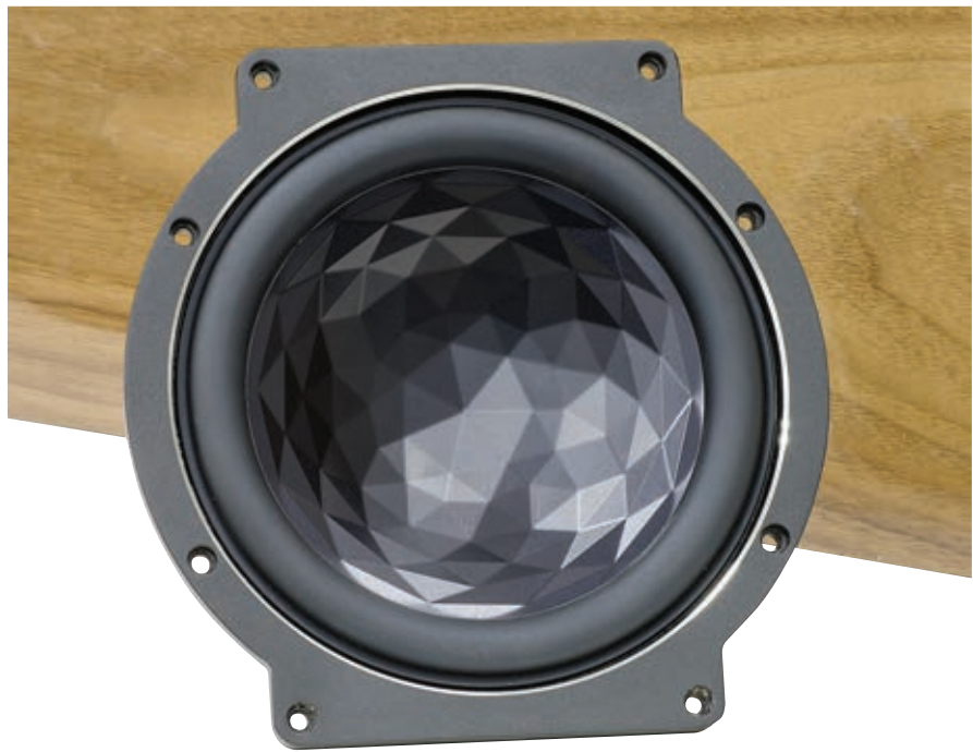
Uno dei due woofer che equipaggia la FS409. La membrana è formata da molte sfaccettature ed è fissata ad un supporto di cellulosa che poi è incollato alla bobina mobile. Notate anche la larghezza della sospensione.
