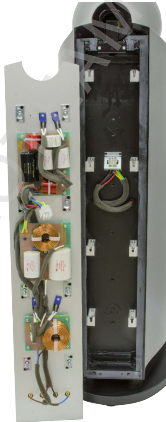
I componenti del filtro crossover passivo sono distribuiti lungo il pannello posteriore in alluminio.
