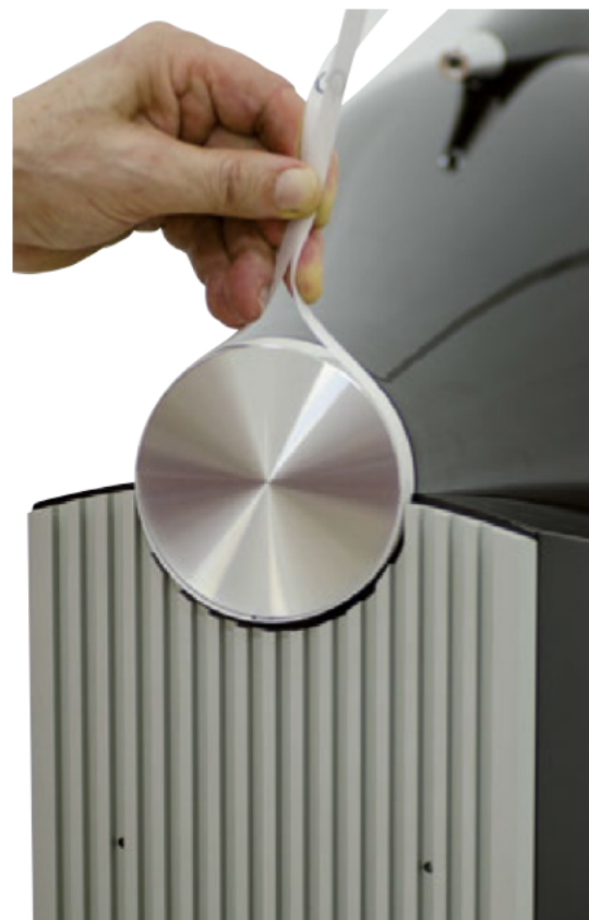
Il tappo della testa a Turbina può essere facilmente rimosso tirandolo verso l'alto con un nastro.
