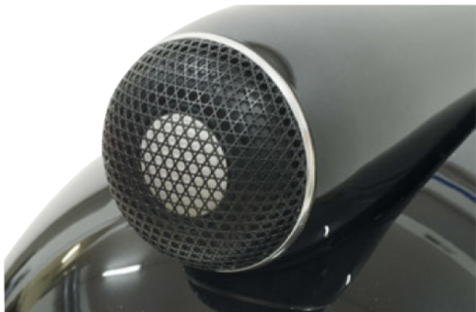
Il tweeter con cupola in diamante è protetto da una griglia non amovibile a meno di utilizzare uno specifico utensile.
