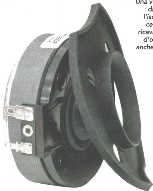
Il tweeter ha la cupola da 29 millimetri senza alcun ferrofluido nel traferro. Notare la flangia frontale che copre l'isolante in gomma che consente un vero disaccoppiamento del trasduttore dal box.
