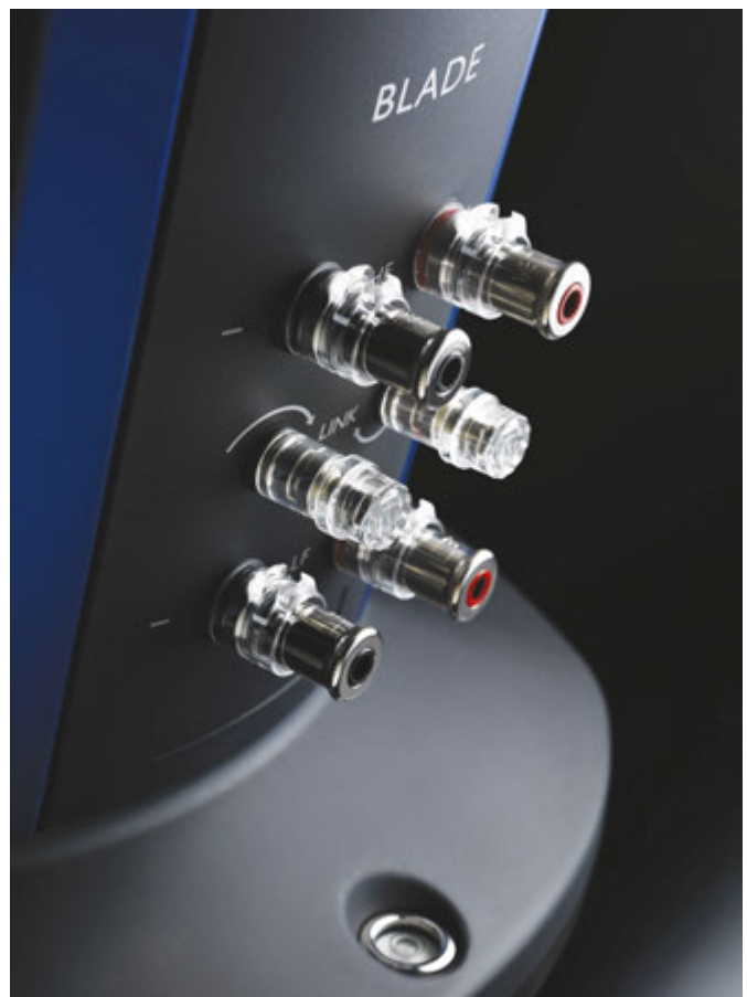
I morsetti posteriori consentono la multiplificazione ed il multicablaggio. Per aprire il corto circuito interno tra i morsetti basta allentare i due pomelli cromati posti tra i morsetti.
