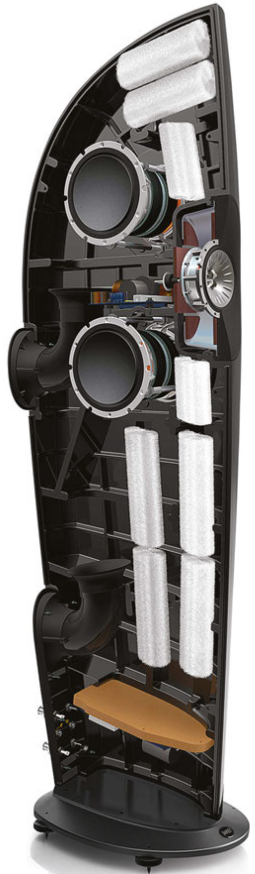
L'interno del diffusore visto in sezione. Notate i rinforzi della struttura per ridurre a minimo le vibrazioni. Il materiale assorbente è arrotolato e sistemato in punti ben precisi della struttura.
